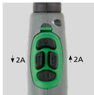
Up/Down Modul mit 4-Funktions-Tasten zur Einstellung des Schweißstroms einschl. TIG-A-Tack-Funktion. Der Schweißstrom wird in Stufen von 2 Ampere erhöht / verringert. Gedrückt halten für ständigen Anstieg / Abfall. Art. Nr. ....80300063* * Gilt Software-Versionen ab 2.17
