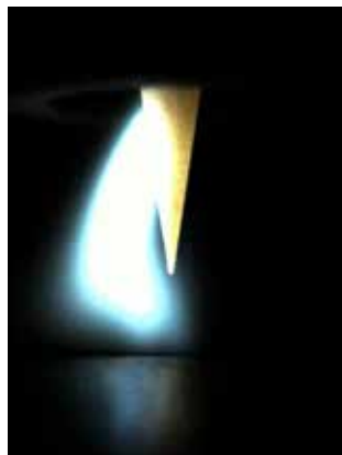
Minderwertige Wolframelektrode: Typische seitliche Zündung des Lichtbogens. Der Bogen flackert und wandert langsam auf die Elektrodenspitze, die dann nachgeschliffen werden muss
