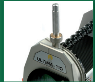
Abflachen der Wolframelektrode in der 90 Gradposition. 1 Punkt an der Noniusschraube gleich 0,1 mm Flächendurchmesser.
